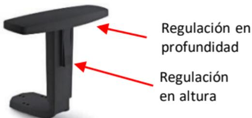
**Ref 272.** 2D Regulables en altura y profundidad. Superficie del brazo en poliuretano blando. La altura se regula pulsando el botón lateral, y la profundidad, deslizando la almohadilla del apoyabrazos.
